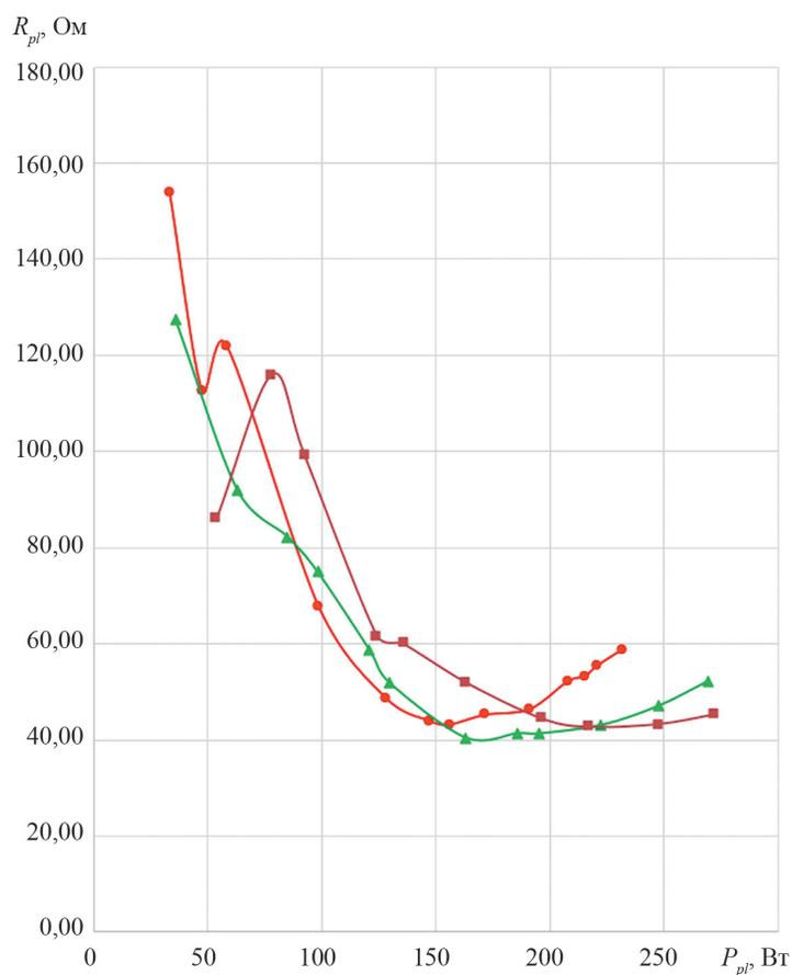
Рис. 4. Зависимости сопротивления плазменного витка  $R_{pl}$  от мощности плазмы  $P_{pl}$ :
