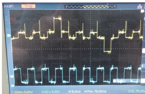
Рис. 2. Симметричное семифазное напряжение (а) и форма фазного напряжения (б, в) (вариант 8)
