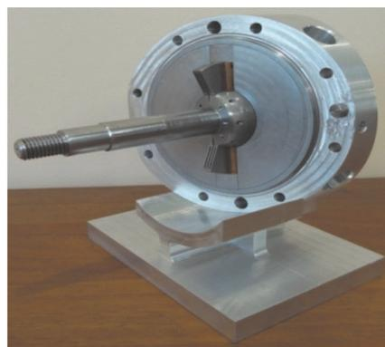
Рис. 22. Энергоустановка для утилизации низкопотенциального тепла на базе роторно-лопастных тепловых двигателей
