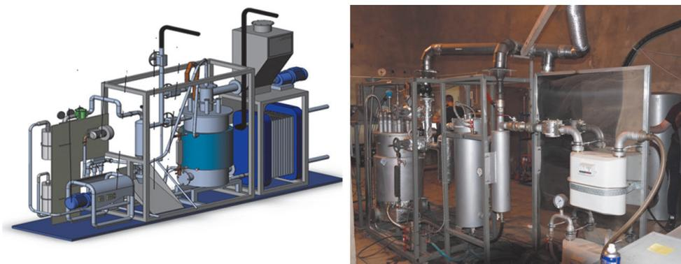
Рис. 21. Когенерационная энергетическая установка мощностью 1,2 кВт на основе газификации твердого органического угля
