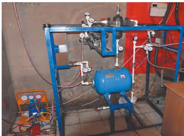
Рис. 23. Энергоустановка для утилизации низкопотенциального тепла на основе органического цикла Ренкина
