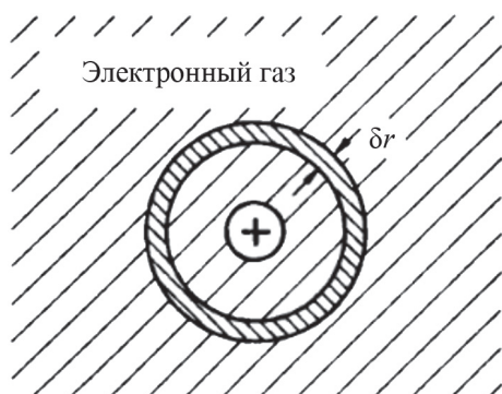
Рис. 1. Электронный газ, испытывающий радиальное сжатие вокруг положительного остова
