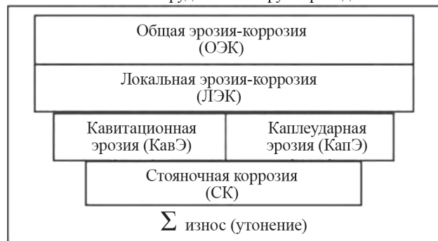
Механизмы повреждения (утонения) металла оборудования и трубопроводов
