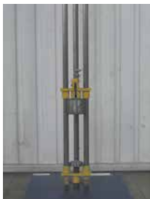
Рис. 1. Испытательная установка для проведения испытаний кабелей на стойкость к удару
