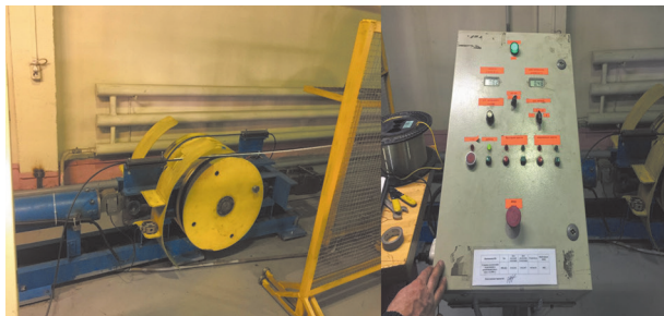
Рис. 3. Испытательная установка для растягивающей и раздавливающей нагрузок типа РРК-ЕК2
