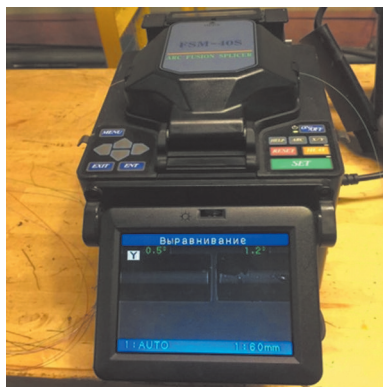
Рис. 4. Автоматический аппарат для сварки оптических волокон «Fujikura 4SM 40S»
