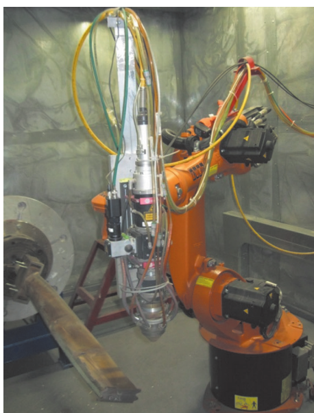
Рис. 6. Лазерная оптическая голова, зафиксированная на роботе-манипуляторе, и рабочая лопатка в процессе восстановления
