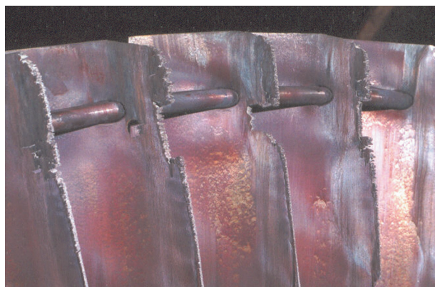
Рис. 1. Эрозионный износ входных кромок рабочих лопаток турбины Т-250/300-23,5 [4]
