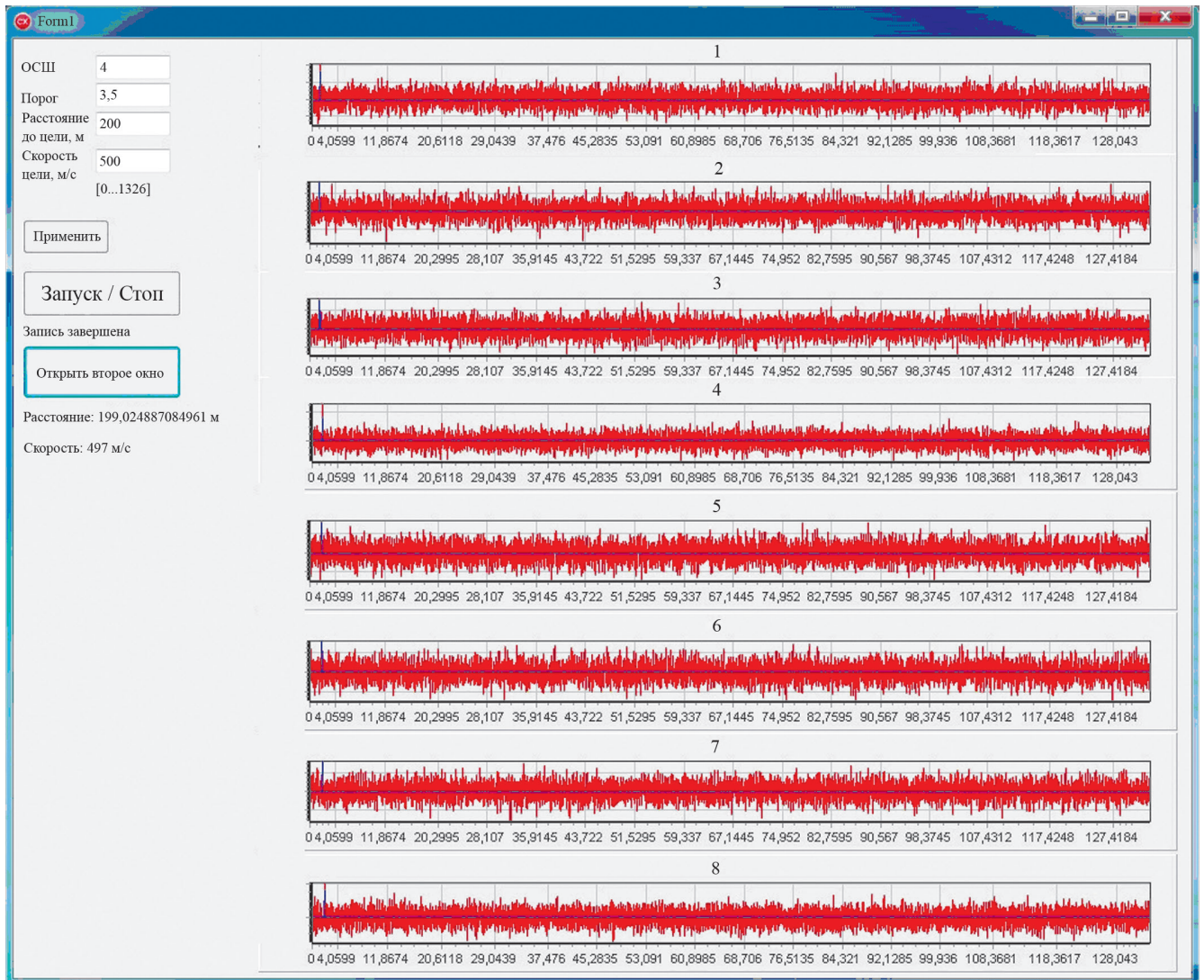
Рис. 5. Основное окно с имитацией поведения сигнала по заданным параметрам и результатами расчета по представленному алгоритму
