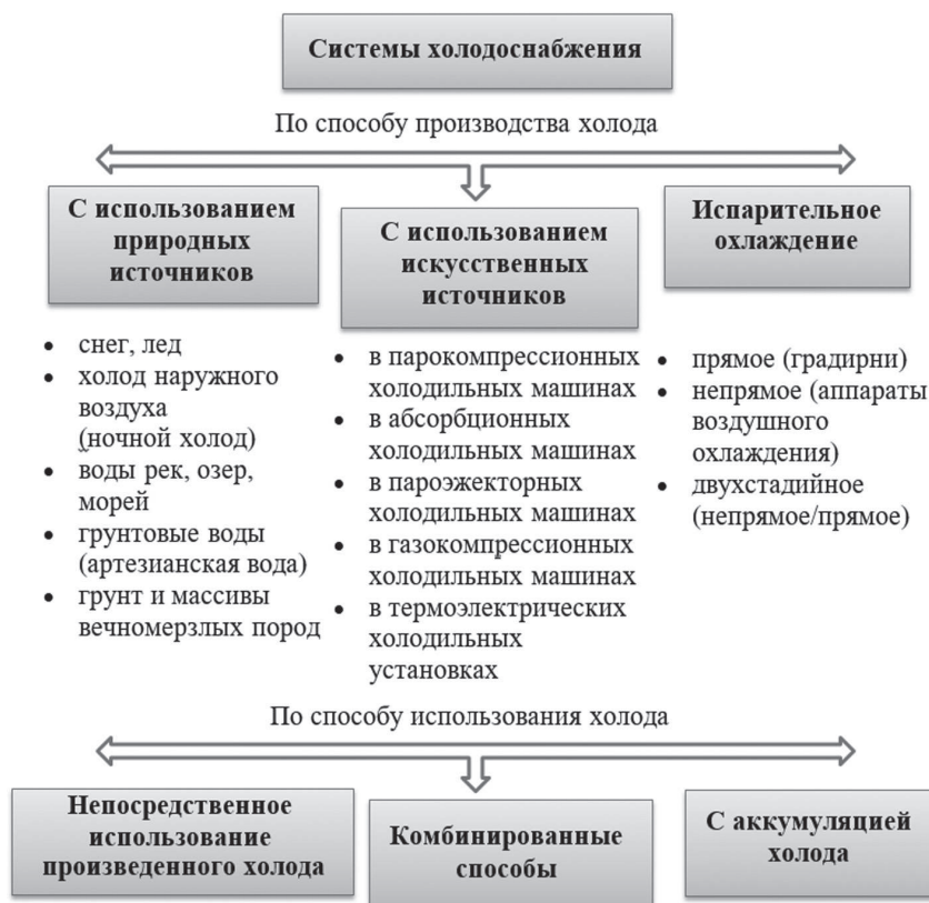
Рис. 1. Классификация систем холодоснабжения
