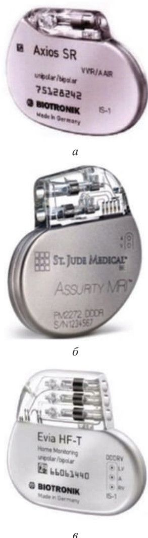
Рис. 1. Имплантируемые электрокардиостимуляторы: однокамерный (а), двухкамерный (б) и трехкамерный (в)
