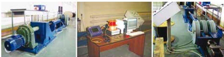
Рис. 3. Испытательный стенд для приложения растягивающего и раздавливающего усилий на ОК
