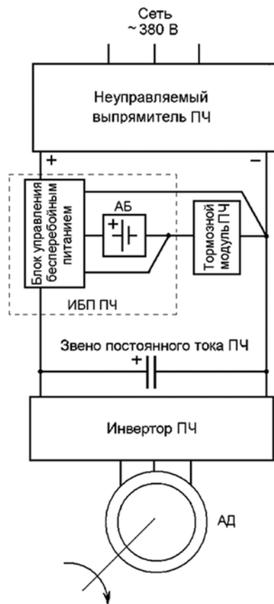
Рис. 3. Функциональная схема электропривода с предложенной системой бесперебойного питания
