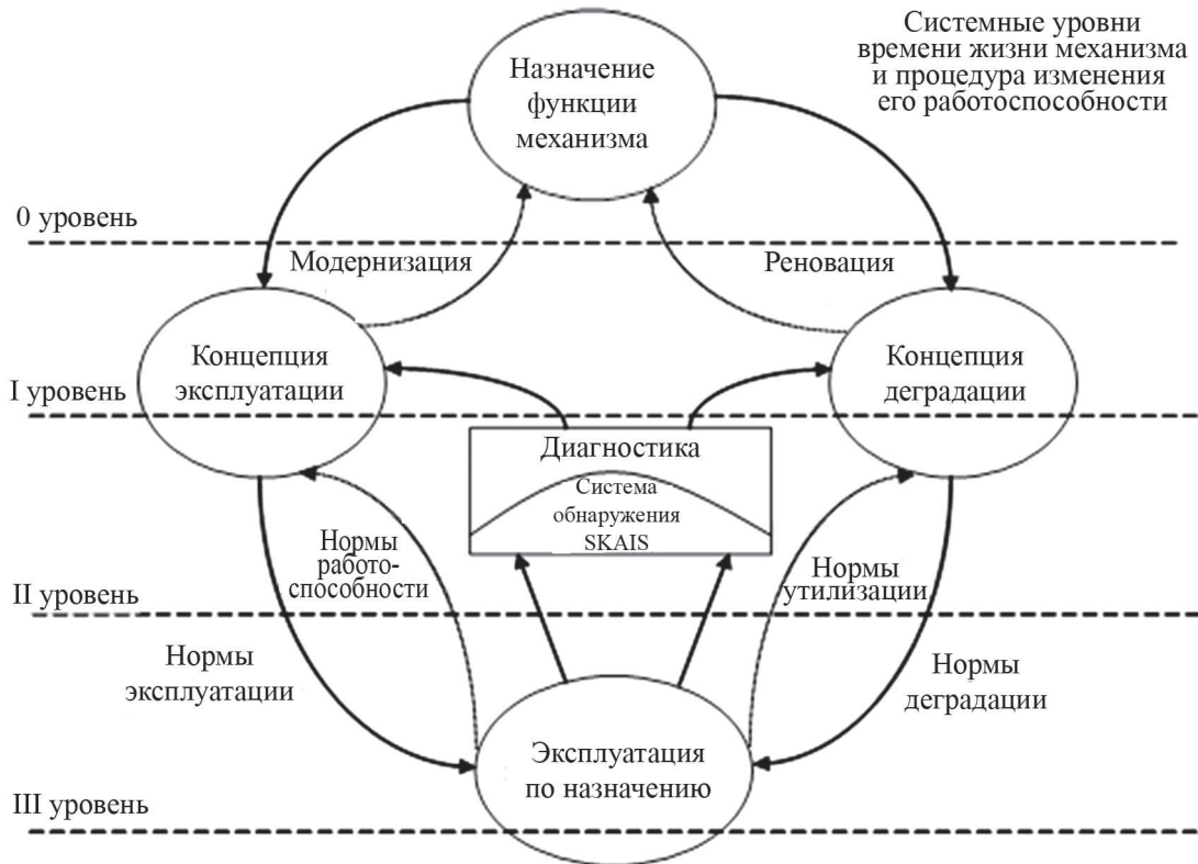
Рис. 2. Концепция мягкого регулирования эксплуатации энергоустановки
