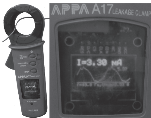
Рис. 4. Общий вид и дисплей модифицированных токоизмерительных клещей
