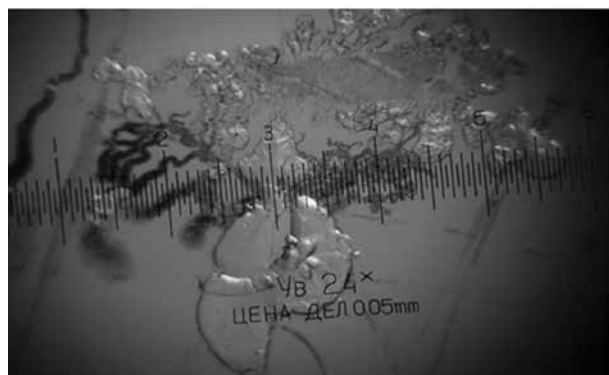
Рис. 4. Фотография разряда стекла на границе отсечки и в устье двух отсечек
