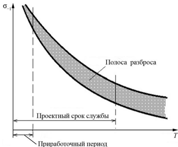
Рис. 3. Дegradация и разброс усталостных свойств материала во времени:
