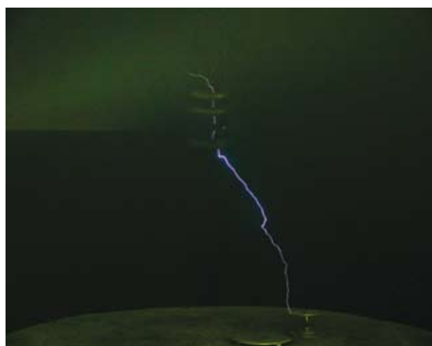
Рис. 5. Канальный разряд с участием гидрометеоров при отрицательной полярности искусственной грозовой ячейки
