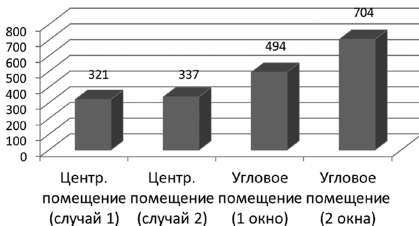
Рис. 3. Суммарные потери тепла через НОК, Вт
